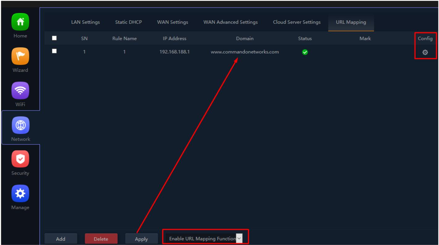
**Fig 4.7.3 URL Mapping setting for AirONE APO750**
